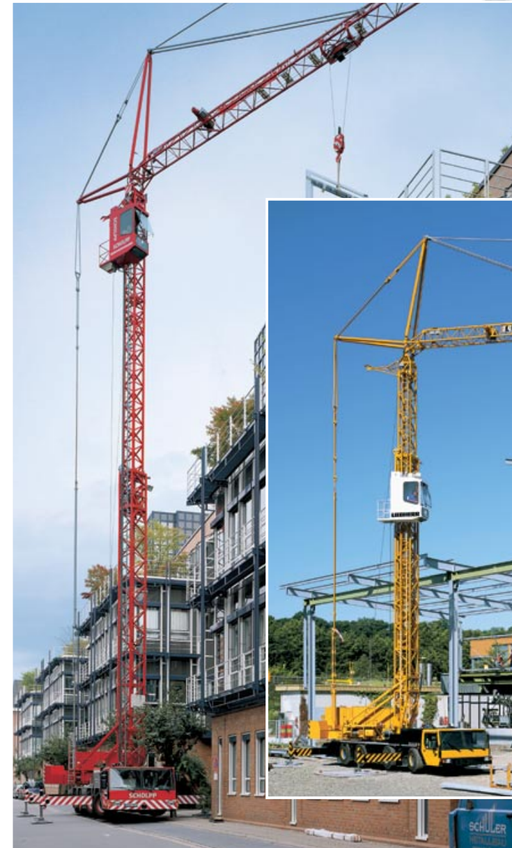
Travail en espace restreint. Hauteur sous crochet : 28,0 m.
