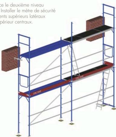
Completar la protección lateral con barandillas superiores y rodapiés.
