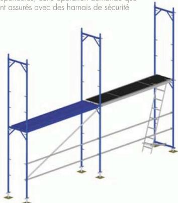
Completar el segundo nivel con barras a 0,5 y 1m. del nivel de plataformas, barandillas laterales y rodapiés centrales y laterales. Arriostar debidamente el andamio a la pared.
